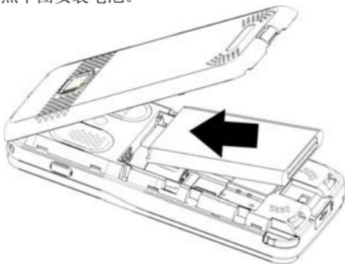
**注意：**请按照图示正确操作以防损坏电池接触点。
